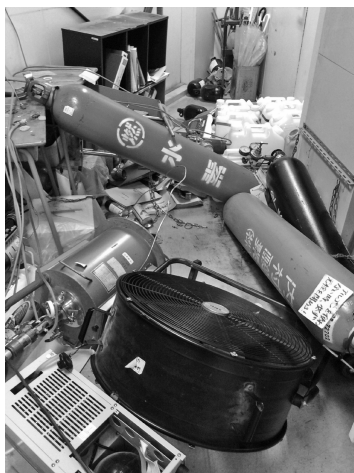
固定部分ごと剥がれ転倒した高圧ポンプ
