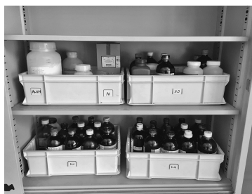
耐薬品性トレイに入れて転倒ないように収納した試薬類
