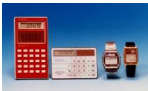
図 4. 世界で最初に工業化された集積型 a-Si 太陽電池搭載ソーラー電卓
